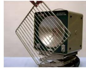
Un polariseur macroscopique à onde radio ( $\lambda > 0,1 \text{ mm}$ )
