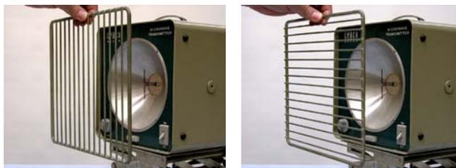
**P.S.** Ce grillage ne permet pas de polariser la lumière dans le visible, car celle-ci possède une longueur d'onde beaucoup plus petite que la distance entre deux barreaux consécutifs.
