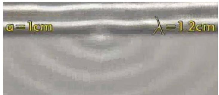
Diffraction d'une onde plane (vague) dans un bac d'eau ( $\lambda > a$ ).
