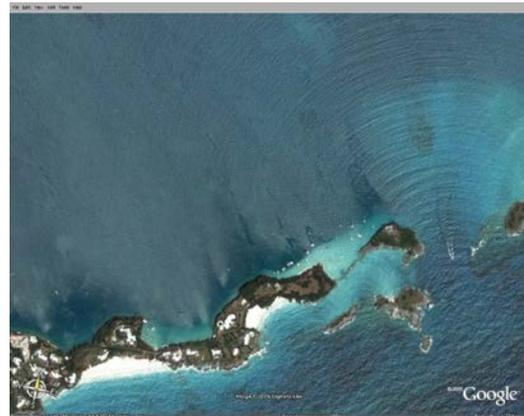
Diffraction d'une vague dans l'ouverture rocheuse
