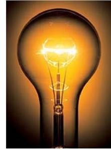
Une ampoule émet de la lumière non polarisée
