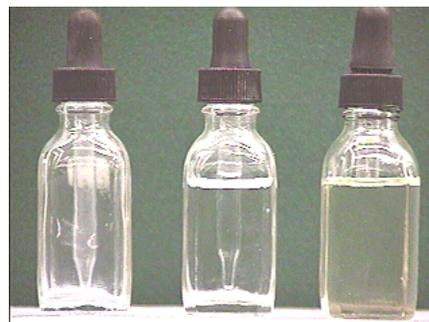
L'indice de réfraction du compte-goutte est identique à celui de l'huile dans la 3<sup>ème</sup> bouteille.
