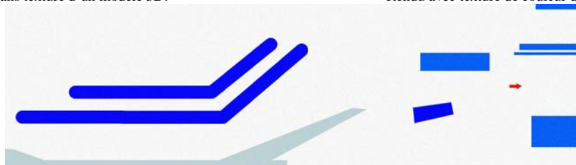
Texture en espace image utilisée pour attribuer différentes couleurs sur les différents triangles du modèle 3D ci-haut.
