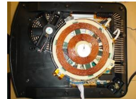
Intérieur de la plaque à induction (19 000 Hz, 160 V)
