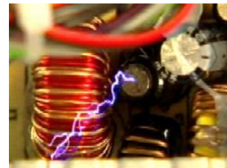
Un court-circuit peut produire des arcs électriques en raison d'une grande différence de potentiel.
