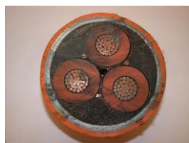
500 mcm (Diamètre : 11 cm) 25 000 V et 1000 A (triphase)
