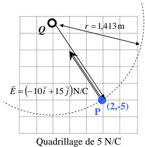
Évaluons la distance selon l'axe  $x$  et  $y$  entre la charge  $Q$  et le point  $\mathbf{P}$  à l'aide de la définition vectorielle du champ électrique généré par une charge ponctuelle :
