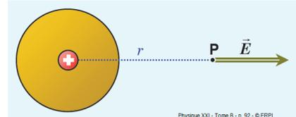
Le champ électrique au point P est équivalent à celui généré par une seule particule regroupant l'ensemble de la charge au centre de la sphère.
