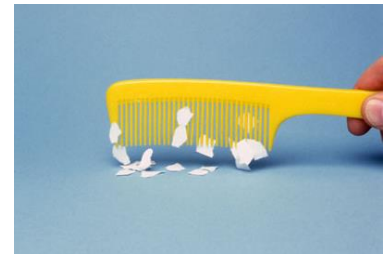
Force électrique qu'applique un peigne chargé par frottement sur des morceaux de papiers neutre.
