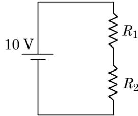
Avec le multimètre en mode voltmètre, mesurez la différence de potentiel  $\Delta V_s$  aux bornes de la source ; faites de même pour la différence de potentiel aux bornes du résistor  $R_1$ , puis aux bornes du résistor  $R_2$  :
