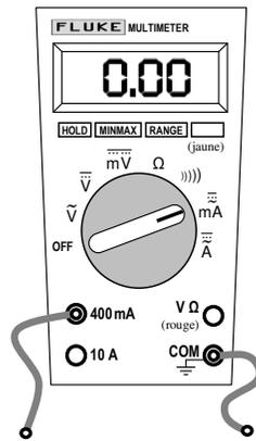
Pour mesurer une résistance ou une différence de potentiel, on a vu qu'il faut brancher le multimètre « en parallèle » avec le résistor ou la portion de circuit qui nous intéresse. En revanche, lorsqu'on utilise un multimètre en mode ampèremètre, *la totalité du courant qu'on désire mesurer doit traverser le multimètre*. Ainsi, le multimètre en mode ampèremètre doit être inséré « en série » à l'endroit du circuit où on veut mesurer le courant.
