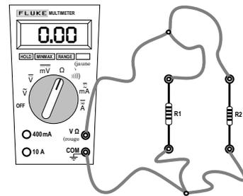
Faites-le (même s'il ne s'agit pas de la manière la plus efficace d'effectuer le branchement) et prenez en note la valeur de la résistance indiquée par l'ohmmètre :
