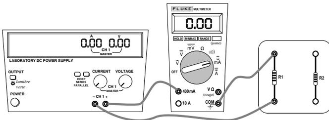
**Attention!** Quand on tourne le bouton rotatif du multimètre pour le placer en position «  $\text{mA}$  », il se règle par défaut en mode «  $\text{AC}$  » (courant alternatif). Dans ce laboratoire, la source produit un courant continu, et il faut appuyer sur le **BOUTON JAUNE** du multimètre pour faire apparaître «  $\text{mA DC}$  » à droite de l'écran («  $\text{DC}$  » pour « direct current », ce qui signifie « courant continu en anglais »).
