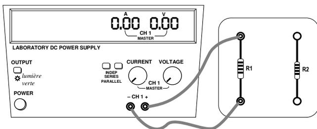
À l'aide du bouton **VOLTAGE** du **CH 1**, réglez le voltage à 10 V.
