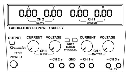
Dans ce laboratoire, nous utiliserons uniquement la sortie **CH 1**. Sur le schéma ci-dessous, nous avons masqué les composants « inutiles » de la source. Nous allons nous servir de la source pour générer un voltage constant. Dépendamment de la résistance du circuit qui sera alimenté par la source, celle-ci générera un courant (en ampères) plus ou moins élevé.
