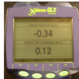
Lecture sur le GLX des mesures effectuées par la sonde.
