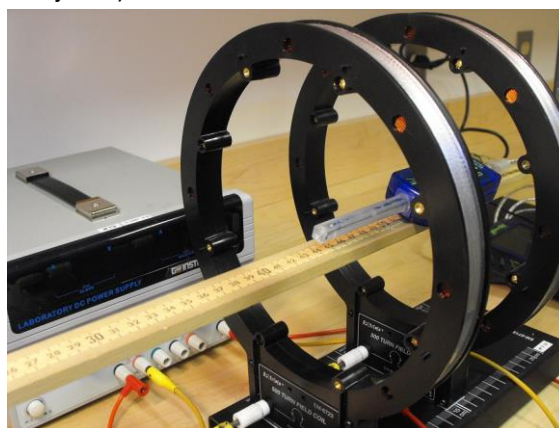
Placez la sonde dans l'axe perpendiculaire au plan de la bobine au centre de la bobine afin d'effectuer votre mise à zéro à l'aide du bouton « Tare ».
