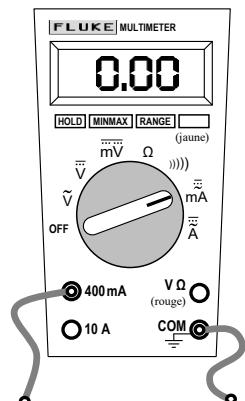
Pour mesurer une différence de potentiel, on a vu qu'il faut brancher le multimètre « en parallèle » avec le résistor ou la portion de circuit qui nous intéresse. En revanche, lorsqu'on utilise un multimètre en mode ampèremètre, la *totalité du courant qu'on désire mesurer doit traverser le multimètre*.
