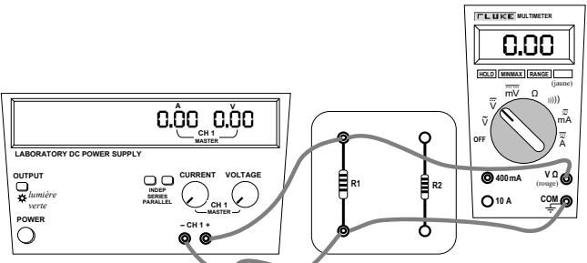
Prenez en note la différence de potentiel aux bornes du résistor  $R_1$  :
