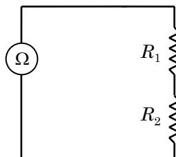
Utilisez les valeurs des résistances  $R_1$  et  $R_2$  que vous venez de mesurer et la théorie de la résistance équivalente des résistors branchés en série pour calculer  $R_{eq} = R_{12}$  (série, calculé), la résistance équivalente du circuit.
