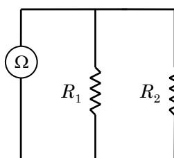
Utilisez les valeurs des résistances  $R_1$  et  $R_2$  que vous venez de mesurer et la théorie de la résistance équivalente des résisteurs branchés en parallèle pour calculer  $R_{eq} = R_{12}$  (parallèle, calculé) la résistance équivalente du circuit.
