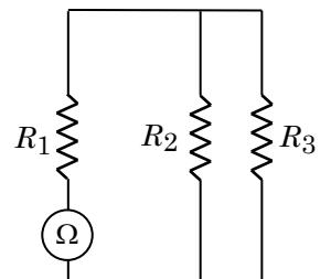
On veut maintenant déterminer la résistance équivalente d'un circuit où  $R_1$  est branché en série avec les résistors  $R_2$  et  $R_3$ , qui sont branchés entre eux en parallèle.
