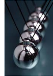
Le pendule de Newton est un bon exemple de collision élastique frontale.
