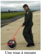
Une roue à mesure est un instrument qui mesure des distances en effectuant un comptage des tours effectués par la roue durant sa rotation tout au long de son déplacement *sans glisser*. La distance parcourue  $d$  est alors le nombre de tours  $N$  multiplié par la circonférence de la roue  $2\pi r$  ce qui donnera l'expression
