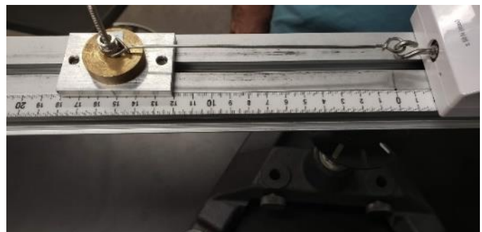
Positionnement du plateau pour obtenir un rayon maximal. Sur l'image, nous pouvons mesurer un rayon d'environ 15 cm.
