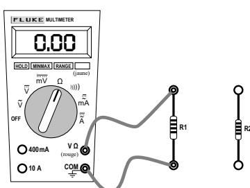
Faites de même pour le résistor  $R_2$ .
