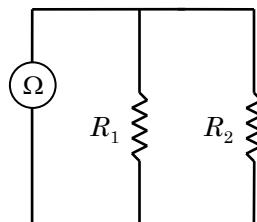
Utilisez les valeurs des résistances  $R_1$  et  $R_2$  que vous venez de mesurer et la théorie de la résistance équivalente des résistors branchés en parallèle pour calculer  $R_{eq}$ , la résistance équivalente du circuit.
