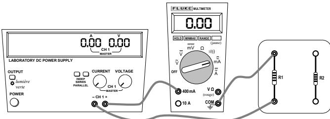
**Attention !** Quand on tourne le bouton rotatif du multimètre pour le placer en position « **mA** », il se règle par défaut en mode « **AC** » (courant alternatif). Dans ce laboratoire, la source produit un courant continu, et il faut appuyer sur le **BOUTON JAUNE** du multimètre pour faire apparaître « **mA DC** » à droite de l'écran (« **DC** » pour « direct current », ce qui signifie « courant continu » en anglais).
