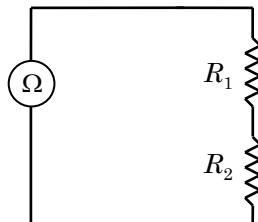
Utilisez les valeurs des résistances  $R_1$  et  $R_2$  que vous venez de mesurer et la théorie de la résistance équivalente des résistors branchés en série pour calculer  $R_{eq}$ , la résistance équivalente du circuit.
