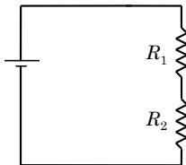
(b) Au laboratoire, vous désirez reproduire le circuit du schéma de la question (a), *mais en remplaçant la pile par le multimètre en mode ohmmètre*. Un ohmmètre est un appareil actif, qui est « sa propre pile » : ainsi, il joue le rôle de la pile quand on veut s'en servir pour mesurer la résistance d'un circuit.
