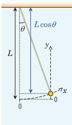
Pour un pendule (schéma ci-contre), l'énergie potentielle est gravitationnelle :  $U = mgy$ . Lorsque la corde de longueur  $L$  fait un angle  $\theta$  avec la verticale, la hauteur  $y$  de la bille par rapport à sa hauteur lorsqu'elle est au centre de l'oscillation est
