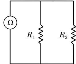
Utilisez les valeurs des résistances  $R_1$  et  $R_2$  que vous venez de mesurer et la théorie de la résistance équivalente des résisteurs branchés en parallèle pour calculer  $R_{eq}$ , la résistance équivalente du circuit.
