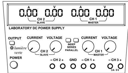
Dans ce laboratoire, nous utiliserons uniquement la sortie **CH 1**. Sur le schéma ci-dessous, nous avons masqué les composantes « inutiles » de la source. Nous allons nous servir de la source pour générer un voltage constant. Dépendamment de la résistance du circuit qui sera alimenté par la source, celle-ci générera un courant (en ampères) plus ou moins élevé.
