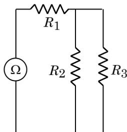
Utilisez la théorie des résisteurs pour calculer la résistance équivalente  $R_{eq}$  du circuit.
