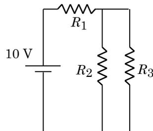
Avec le multimètre en mode ampèremètre (assurez-vous qu'il est bien réglé en mode « **mA DC** »), mesurez le courant  $I_S$  débité par la source, le courant  $I_1$  qui circule dans le résistor  $R_1$ , le courant  $I_2$  qui circule dans le résistor  $R_2$ , et le courant  $I_3$  qui circule dans le résistor  $R_3$  :
