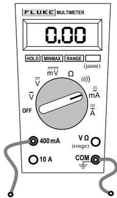
Pour mesurer une différence de potentiel, on a vu qu'il faut brancher le multimètre « en parallèle » avec le résistor ou la portion de circuit qui nous intéresse. En revanche, lorsqu'on utilise un multimètre en mode ampèremètre, la totalité du courant qu'on désire mesurer doit traverser le multimètre. Ainsi, le multimètre en mode ampèremètre doit être inséré « en série » à l'endroit du circuit où on veut mesurer le courant.
