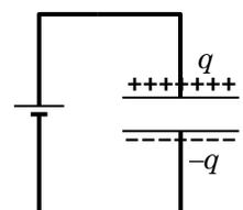
Quand on dit qu'un condensateur possède une certaine charge  $q$ , cela veut dire qu'une des armatures porte une charge  $q$  et que l'autre porte une charge  $-q$ . La charge totale d'un condensateur est toujours nulle :  $q_{\text{tot}} = q + (-q) = 0$ .
