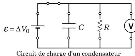
Une fois le condensateur chargé, on ouvre l'interrupteur (schéma ci-contre). La pile étant mise hors circuit, le condensateur se décharge à travers le résisteur. À chaque instant, la tension aux bornes du condensateur est égale à la tension aux bornes du résisteur : cette tension est indiquée par le voltmètre. Elle diminuera continuellement lors de la décharge, au fur à mesure que les charges emmagasinées sur les plaques du condensateur passent dans le circuit pour se « neutraliser ».
