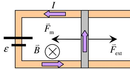
Pour que la force magnétique soit orientée dans le sens négatif de l'axe  $x$ , le courant doit circuler vers le haut de la tige. Évaluons le courant qui circule dans le circuit pour générer la force magnétique :
