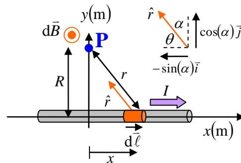
Introduisons un nouveau système d'axe  $\alpha$  qui mesure un angle par rapport à l'axe vertical  $y$ . Ce système d'axe permet de délimiter les extrémités du fil A et B. Dans ce cas particulier,  $\alpha_A < 0$  et  $\alpha_B > 0$ .
