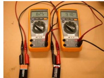
Pile presque vide (gauche) et pile pleine (droite)
