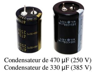
Un condensateur possède toujours une **charge totale nulle**. Lorsqu'on qu'un condensateur est dit « chargé », c'est qu'il possède une charge  $+q$  (déficit d'électrons) sur une plaque et une charge  $-q$  (excédant d'électron) sur l'autre.
