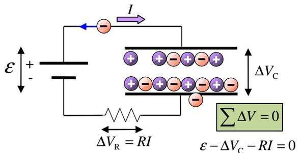
Le processus de chargement cesse lorsque l'électromotance  $\varepsilon$  de la pile est égale à la différence de potentiel  $\Delta V_C$  du condensateur. Le courant  $I$  chute à zéro.
