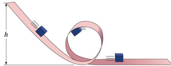
Un objet au repos est relâché d'une hauteur  $h$ . Quelle est la plus petite hauteur  $h$  possible pour que l'objet soit capable de parcourir toute la boucle (de rayon  $r$ )?
